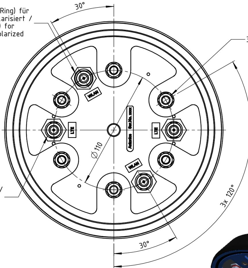
3x M8-Verschraubung / M8 screwing
