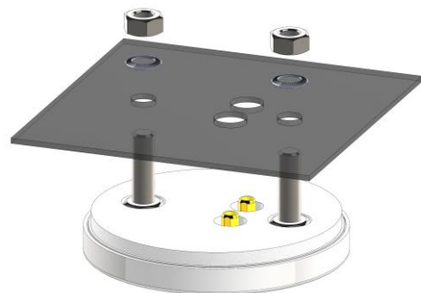
Bild 3: Prinzipielle Darstellung der Montage von TOP 90 (2 Bolzen)
